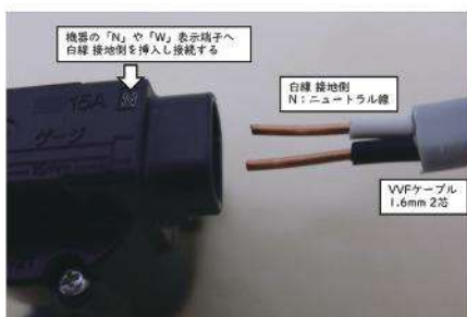
(画像1) 電気機器への電線の接続
